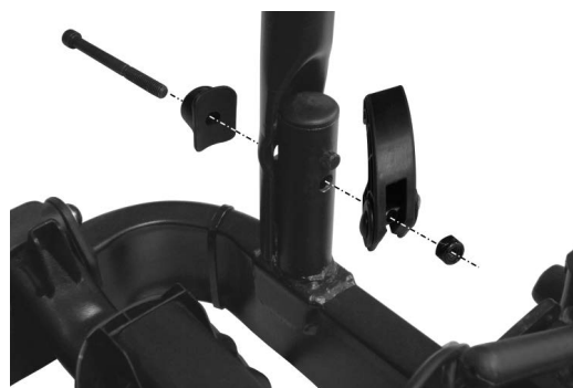
Figura 3: Fissaggio della staffa a U
