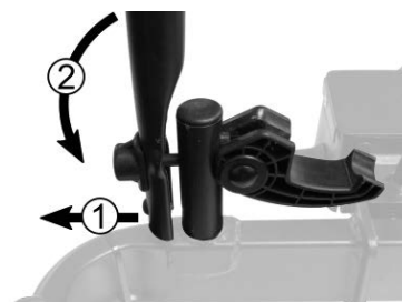
Figure 26 : Déverrouiller et rabattre l'étrier en U
