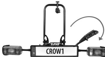
Figure 17: Dépliage des rails de roues de droite
