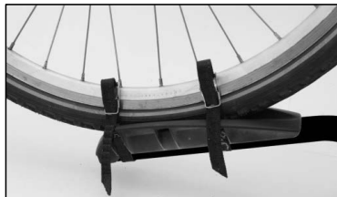
Figura 21: Cinghie di fissaggio ruota anteriore
