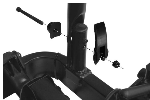
Figure 3 : Fixation de l'étrier en U
