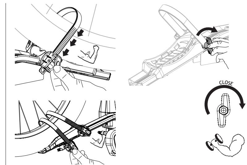
(FR) Déverrouillez les supports de roue en dévissant le bouton (X), faites glisser les supports de roue sur le rail en les adaptant au vélo à transporter, une fois la position correcte trouvée, fixez la sangle puis revissez le bouton. Utilisez le support à double sangle pour fixer la roue avant.
