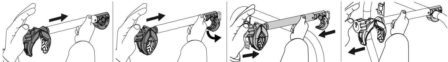
(FR) Dévissez la molette de quelques tours, puis appuyez sur la molette pour actionner la mâchoire arrière, plus vous dévissez la molette, plus la mâchoire s'ouvre. Positionnez le bras de verrouillage du vélo dans la position la plus appropriée en fonction de la forme du cadre du vélo, puis vissez le bouton pour serrer le collier de serrage du cadre sur le vélo .
