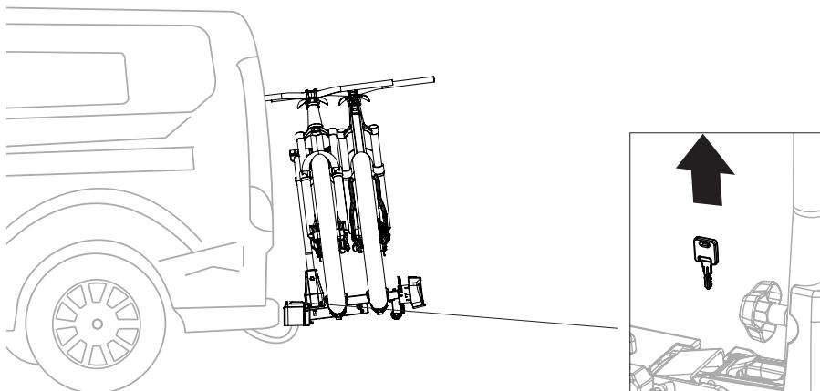
(FR) Dans le cas d'un véhicule dont le hayon est long, retirez toujours la clé avant de l'ouvrir.
