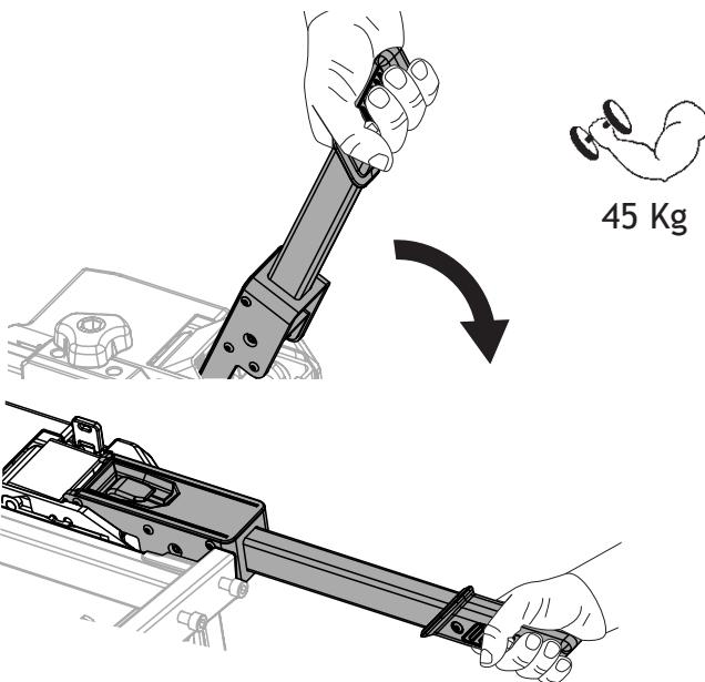
(FR) Pour augmenter la force de fermeture, tournez manuellement la vis d'1/4 de tour, puis abaissez le levier et vérifiez le serrage du produit, si nécessaire répétez l'opération jusqu'à trouver la fixation correcte.
