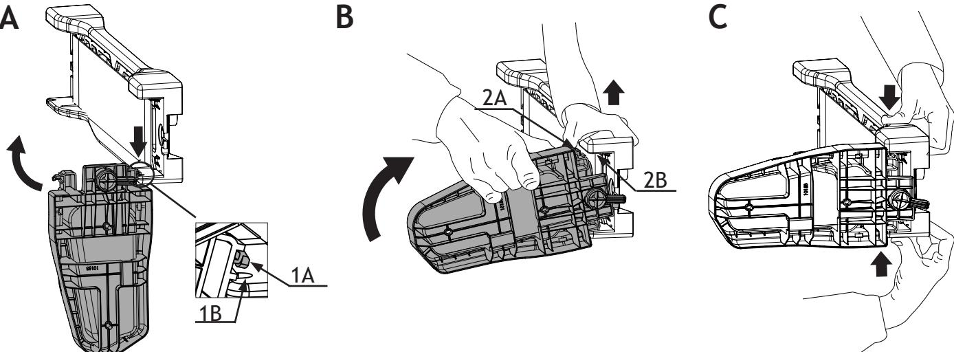
(FR) Insérez la goupille 1A dans le trou 1B du support de la plaque d'immatriculation, tournez le support de la lampe de façon à ce que la goupille 2A soit insérée dans le trou 2B (image B), si nécessaire, tirez légèrement sur le support de la plaque d'immatriculation, une fois en position, pousser sur le support de la plaque d'immatriculation comme indiqué sur l'image C de façon à ce que les goupilles s'enclenchent.
