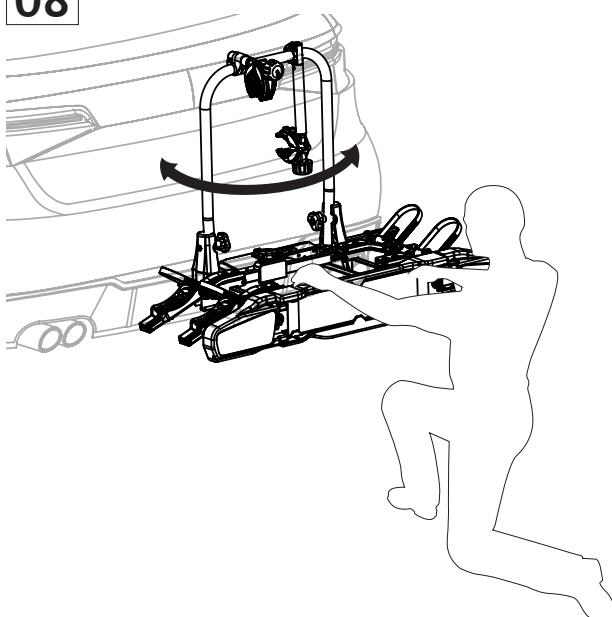
(FR) Vérifiez si le porte-vélo ne tourne pas, s'il est fixe, passez à l'étape 10, sinon passez à l'étape 09 pour régler le système de fixation.
